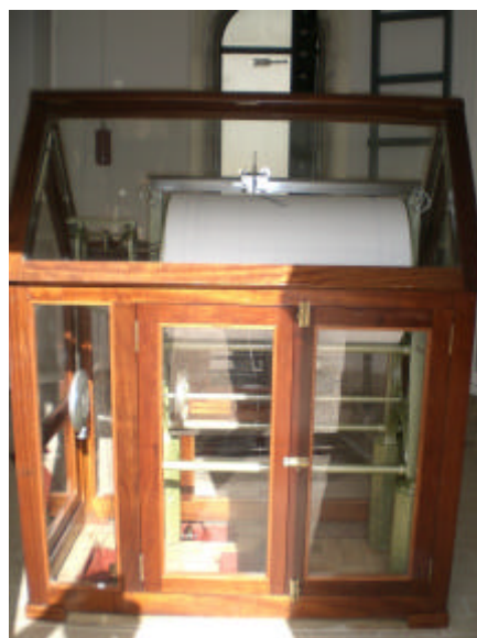
Nestas imagens é visível o pormenor do marégrafo, já montado, sem e com o armário.
